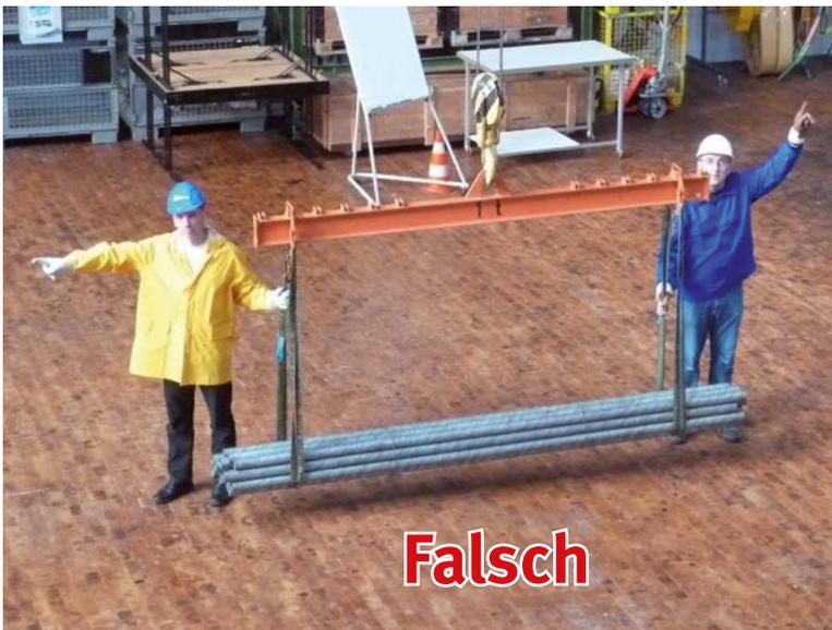
Bild 5-14: Auf welches Zeichen soll der Kranführer reagieren? Heben oder Fahren?
