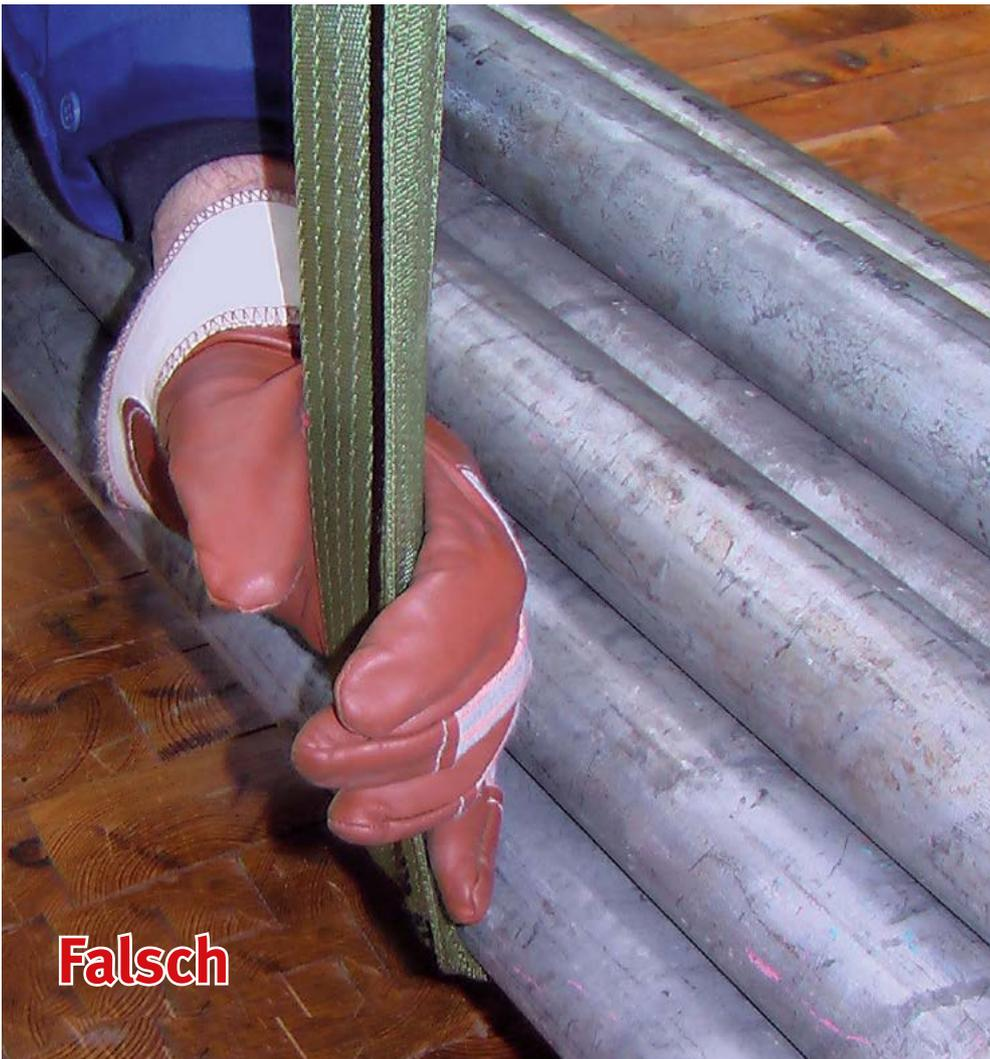
Bild 5-16: Wenn der Kranführer in dieser Situation anhebt, kann die Hand des Anschlägers gequetscht werden
