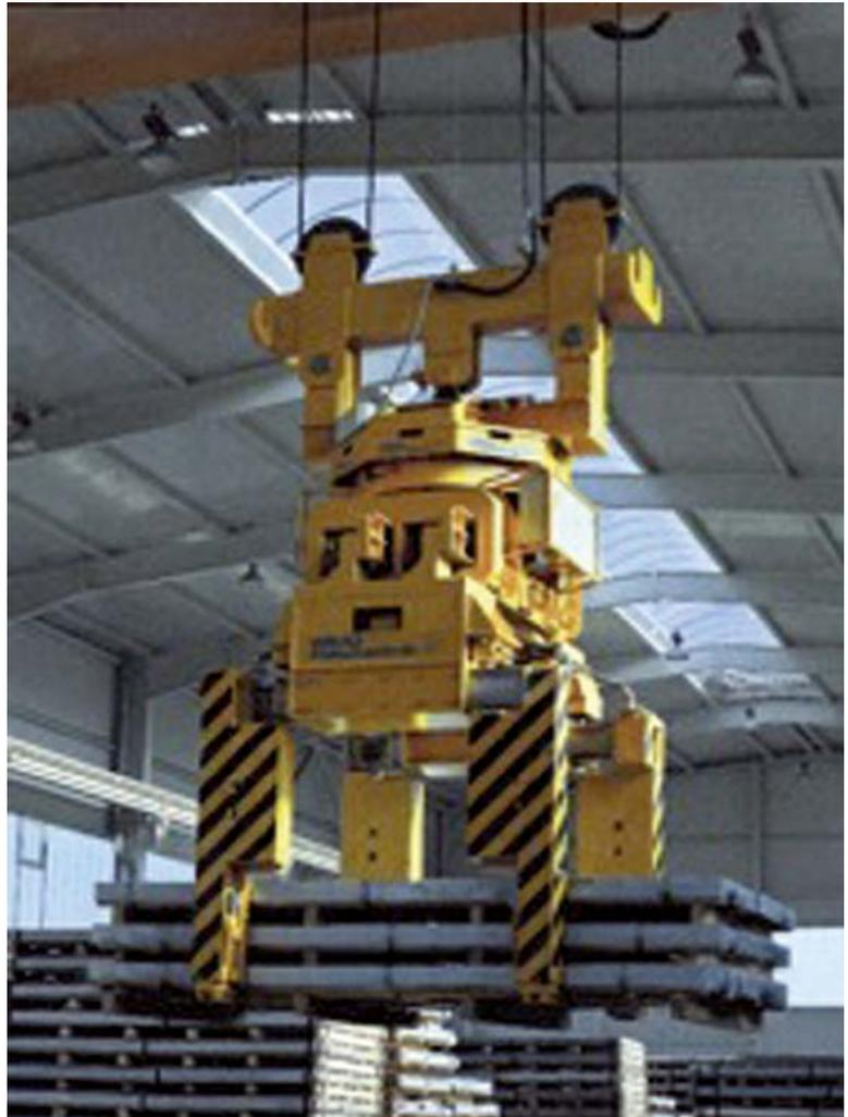
Bild 5-10: Motorisch angetriebene Zange
