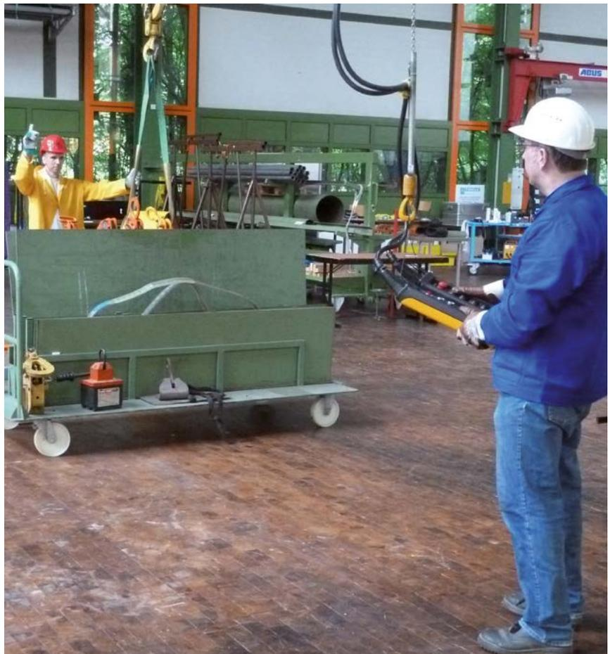
Bild 5-1: Kann der Kranführer die Last oder bei Leerfahrt die Lastaufnahmeeinrichtung nicht einsehen, darf er den Kran nur auf Zeichen eines Einweisers steuern
