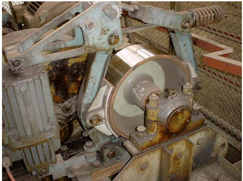
Bild 4-4: Inaugenscheinnahme einer Trommelbremse
