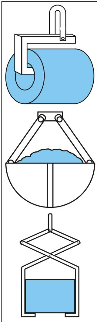
Bild 5-8: Prinzip der formschlüssigen Lastaufnahme
