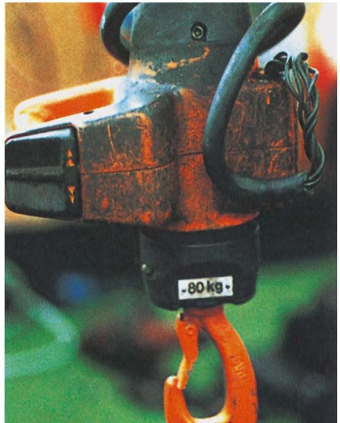
Bild 4-3: ... ein aus der Einführung herausgerutsches Zuführkabel oder eine defekte Zugentlastung, darf er den Kran nicht in Betrieb nehmen
