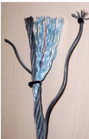
Bild 8-2: Aufbau eines Litzenseiles
