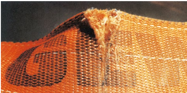
Bild 23-14: Durch scharfkantige Last eingeschnittenes Hebebänder
