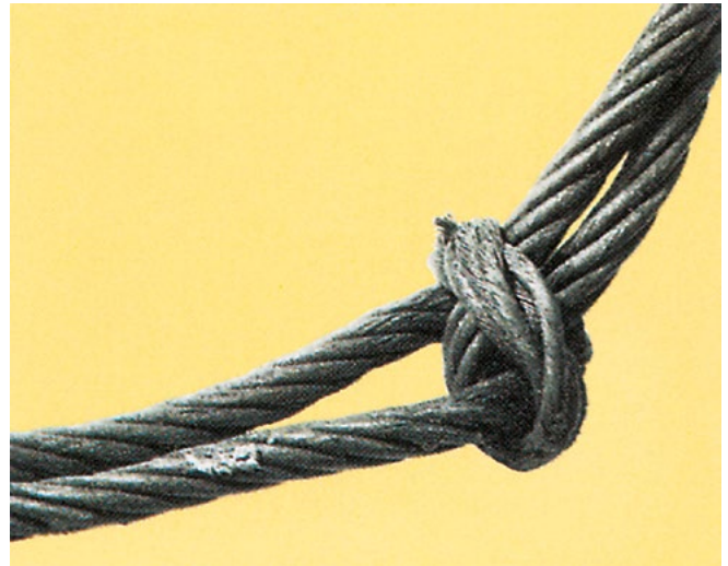
Bild 9-2: Unzulässiger Knoten zerstört den Seilverbund
