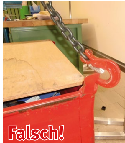
Bild 16-4: Haken rutschen bei Schlaffketten aus den Ösen
