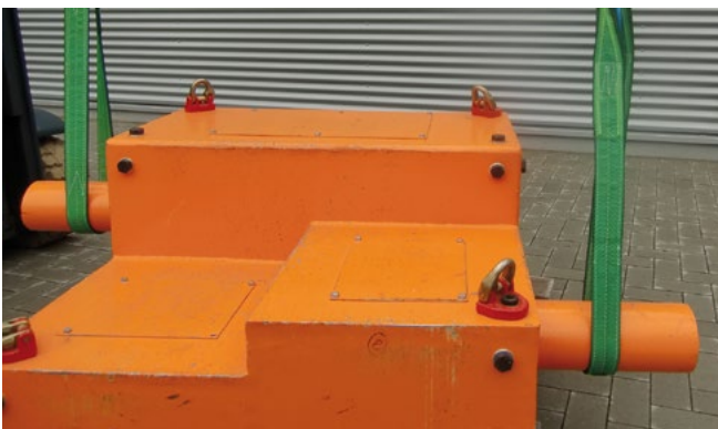
Bild 6-2: Hebebänder sind oberflächenschonend
