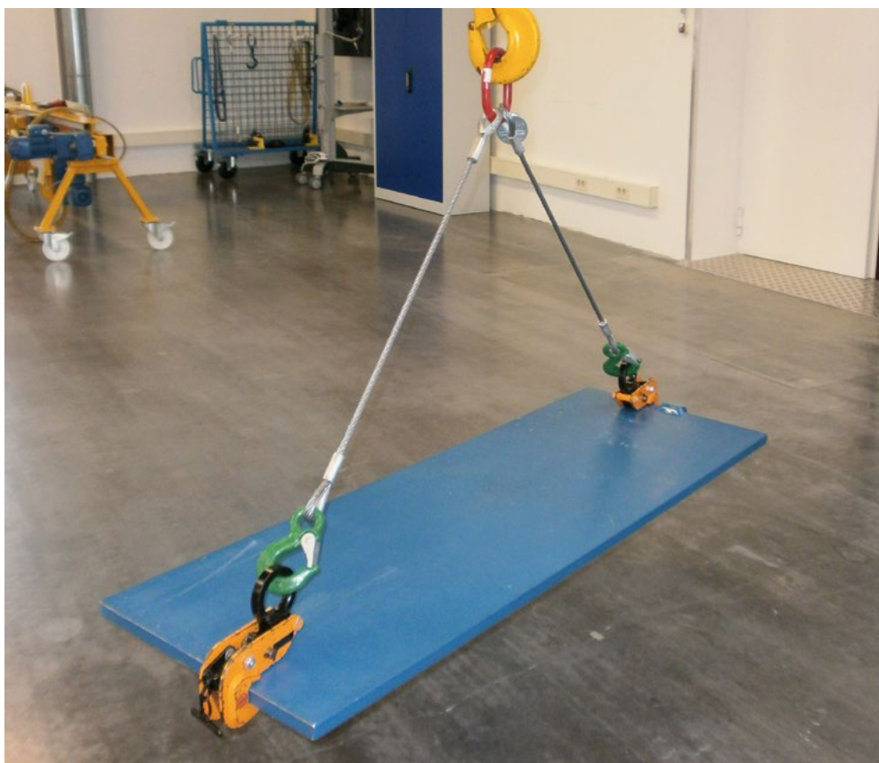
Bild 13-1: Blech horizontal sicher transportiert
