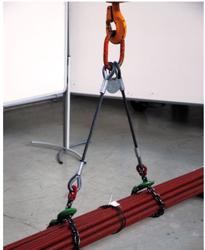
Bild 6-1: Kombination Seil/Kette zur Schonung der Drahtseile
