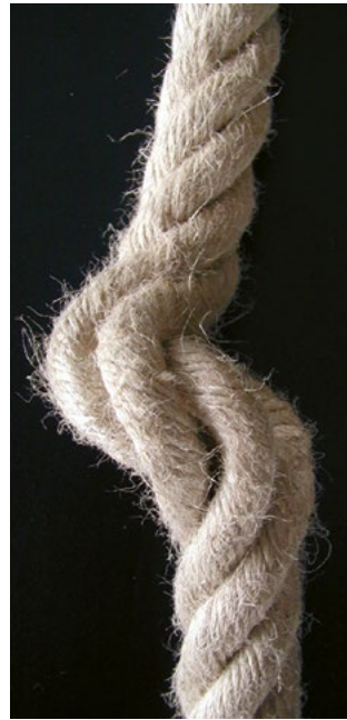
Bild 23-8: Durch Klanke zerstörter Litzenverbund
