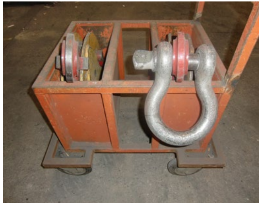
Bild 24-2: Abgestellte, gegen Umfallen gesicherte Lastaufnahmemittel
