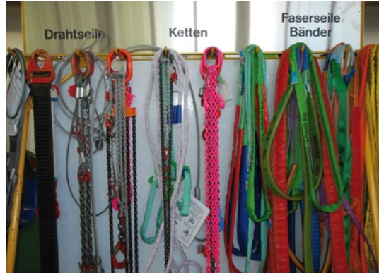
Bild 24-1: Vorbildliche Aufbewahrung von Seilen und Ketten
