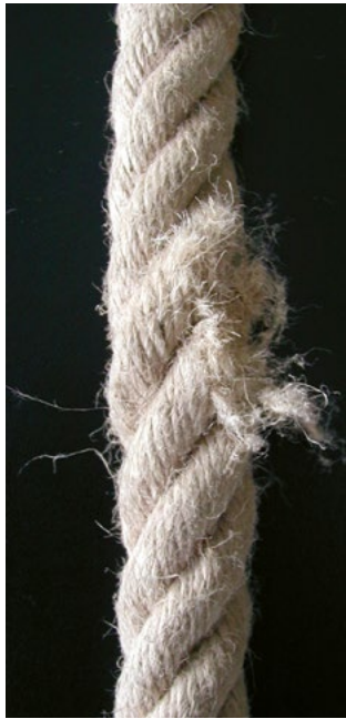
Bild 23-7: Zerstörung einer Litze
