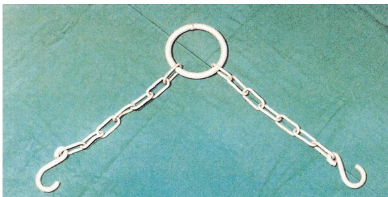
Bild 11-1: Eine langgliedrige Kette darf selbst im Neuzustand nicht als Anschlagmittel verwendet werden. Die Kettenlieder verbiegen!
