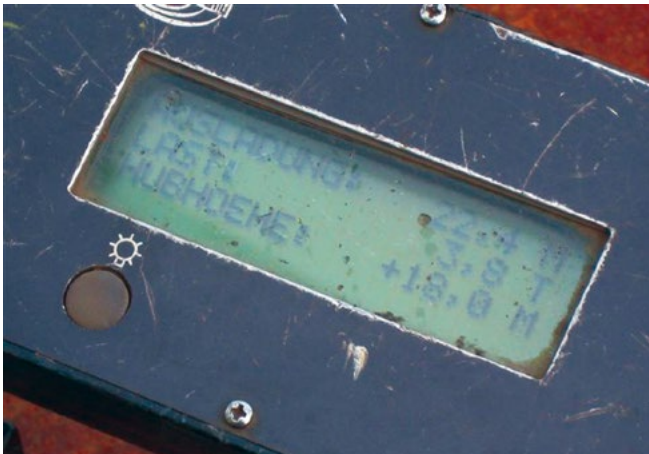
Bild 5-3: Steuerbirne mit digitaler Lastanzeige
