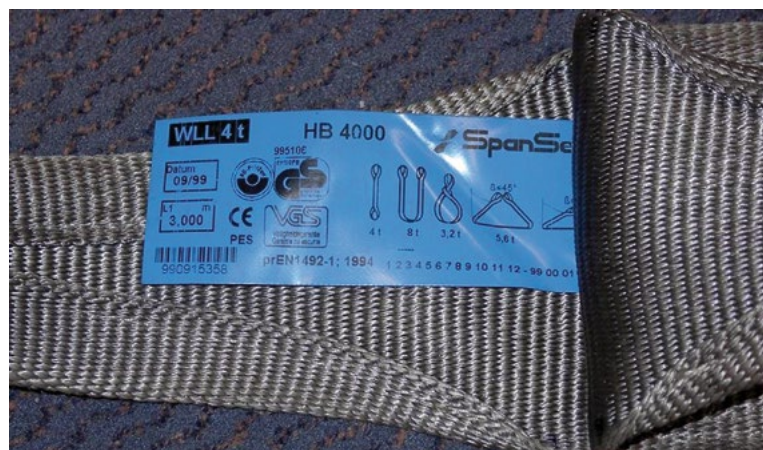
Bild 10-1: Polyester-Hebeband mit eingewebtem Etikett
