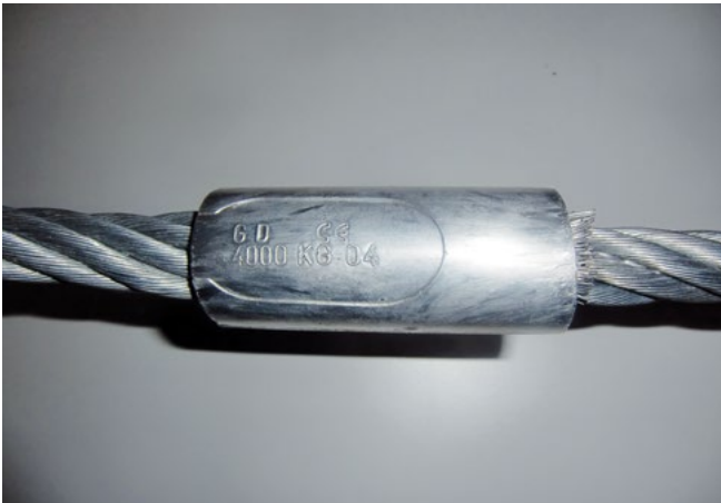
Bild 9-1: Pressklemme mit Verpresserkennzeichen
