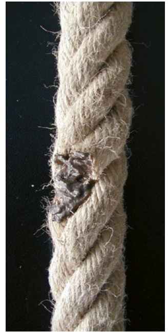
Bild 23-9: Wärmeeinfluss hat eine Litze zerstört
