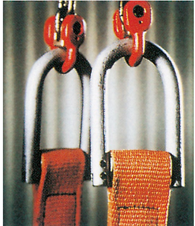
Bild 12-1: Kombination Kette – Hebeband
