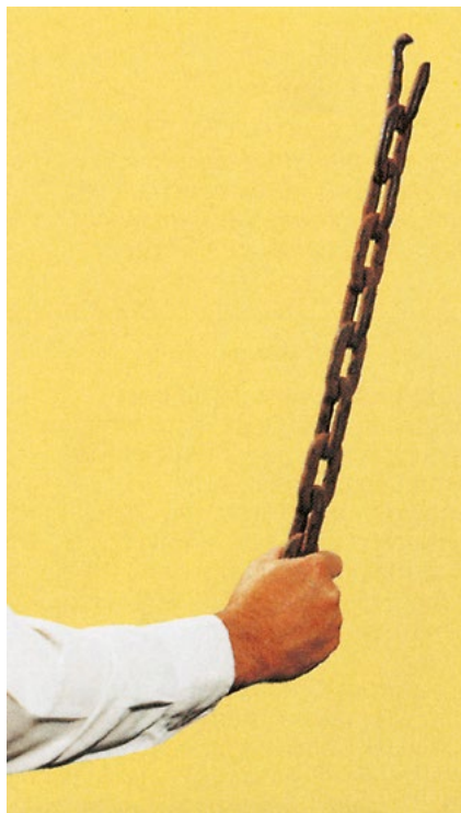
Bild 23-11: Durch Überlastung steif gezogene Kette
