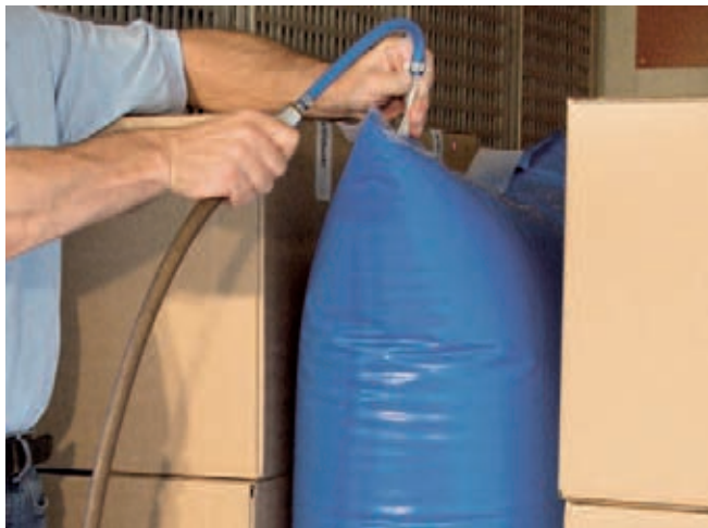
Stausack als Zwischenraumfüllung
