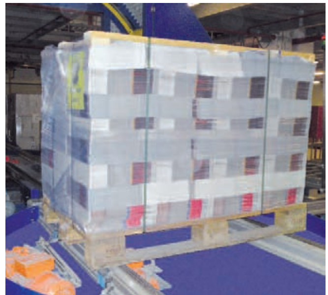
Palette mit Kopfplatte, Umreifung und horizontaler Folienstretchung
