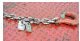
Diese Ketten haben einen zweiten Anhänger mit dem Prüfdatum.
