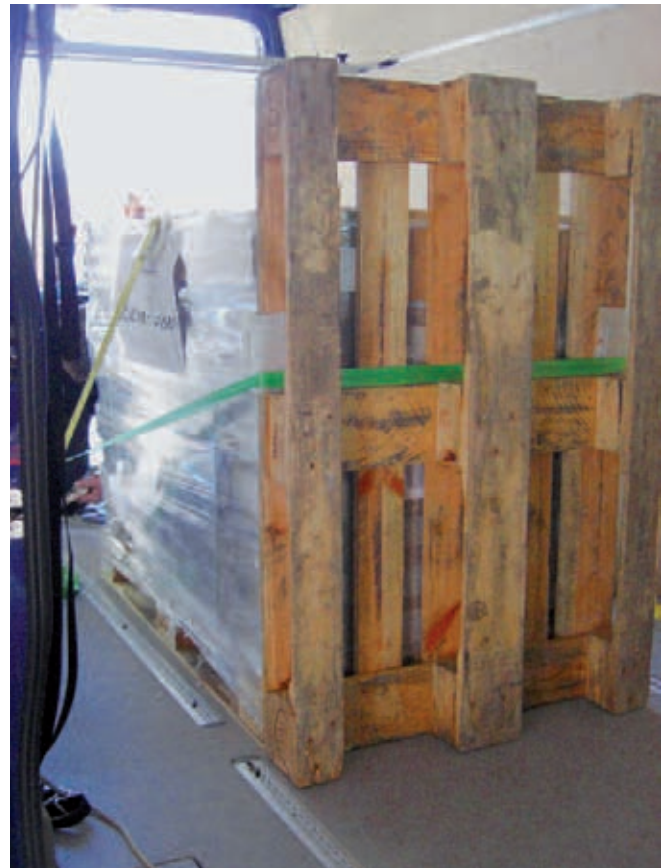
oben: Sicherung nach vorne durch Kopfschlinge mittels Zurrgurt und Palette
