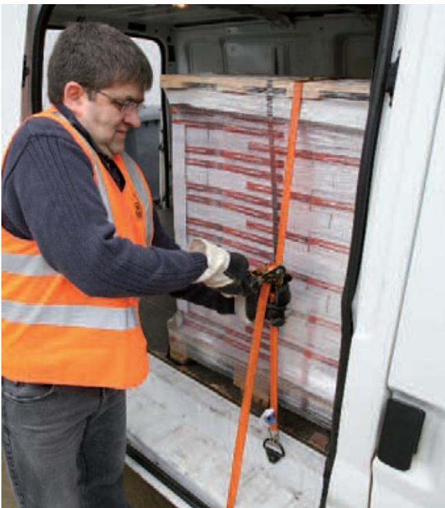
Niederzurren einer formstabilen Palettenware
