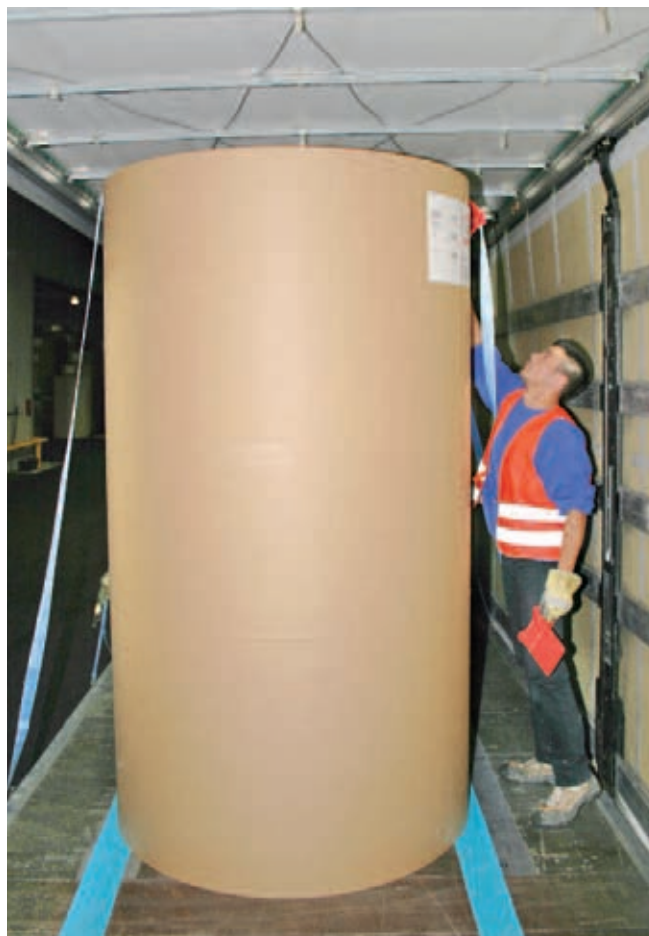
Der Einsatz von Kantenschutzwinkeln vermeidet Beschädigungen an den Rollenkanten.
