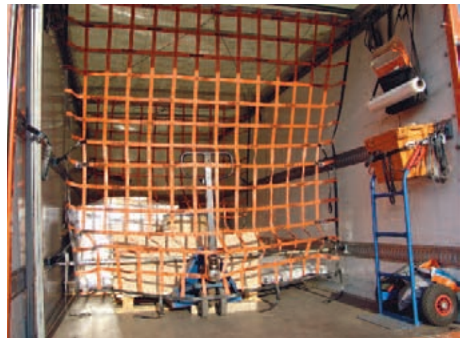
Netz zur Laderaumabtrennung
