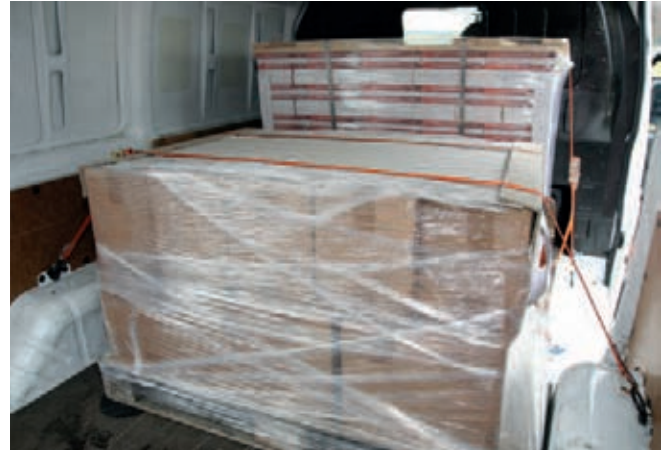
Einsatz von Kantenschutz
