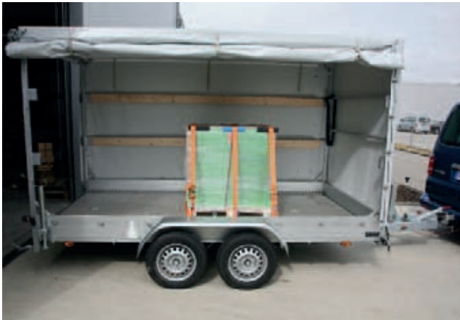
Ordnungsgemäße Lastverteilung auf einem Anhänger
