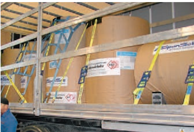
Kombination aus Zurrgurten und -netzen
