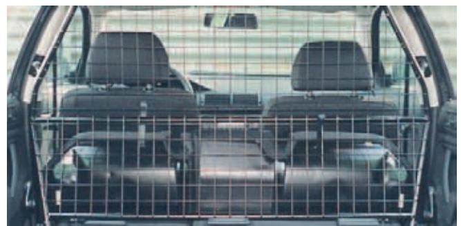
Nachträglich eingebautes Trenngitter nach DIN 75410-2
