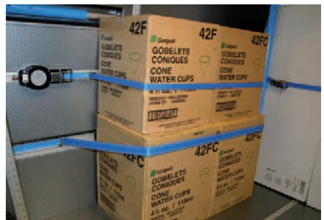
Fest installiertes Gurtsystem
