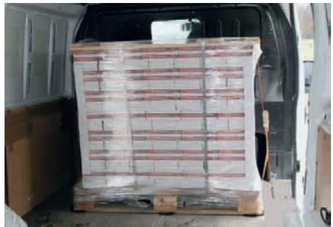
Ansicht von hinten: Der Zurrband verläuft etwa im Winkel von 90°, wodurch annähernd die gesamte Vorspannkraft des Zurrmittels in das Ladegut eingeleitet wird. Da die Bücherpalette einer ordnungsgemäßen transportfähigen Ladeinheit entspricht, ist die Ladungssicherung entsprechend der technischen Normen möglich.
