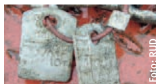
Diese Ketten haben einen zweiten Anhänger mit dem Prüfdatum.
