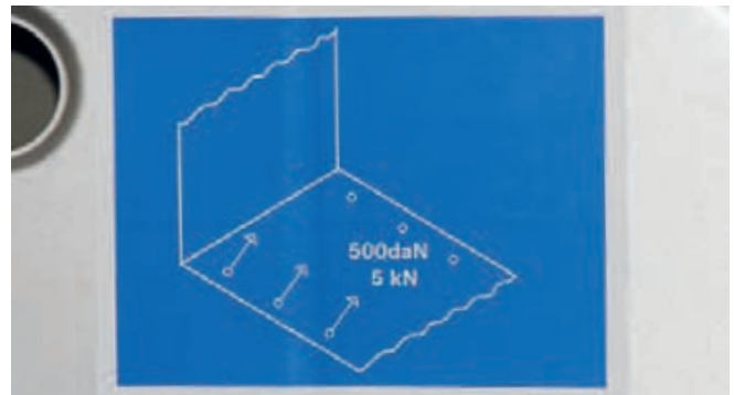
Kennzeichnung von Zurpunkten
