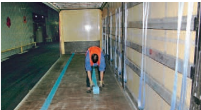
Ausrollen des rutschhemmenden Materials
