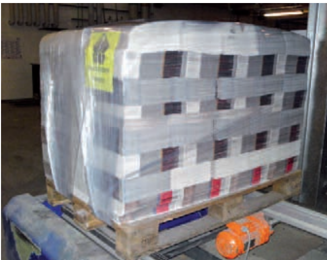
Kombination aus Horizontal- und Fallschirmstretchung (Stretchfolie zwischen den Kufen)
