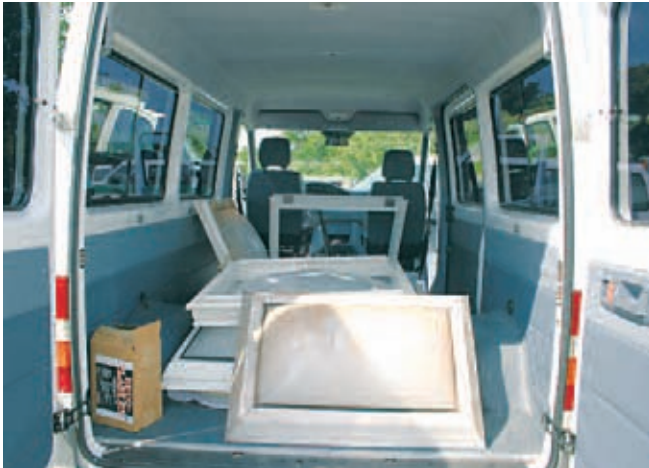
Diese Dachluken können die Fahrzeuginsassen verletzen.
