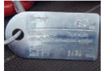
Beispiele von Zurrketten mit Kennzeichnungsanhängern
