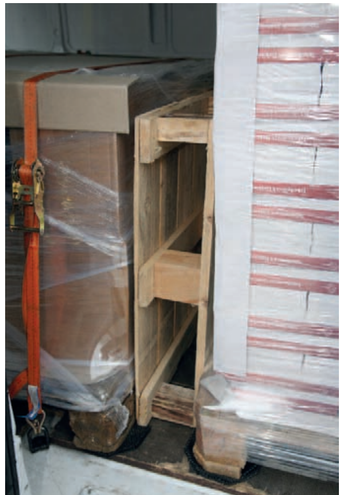
Aufgrund des überstehenden Kopfdeckels der hinteren Palette ist kein direkter Formschluss zur vorderen Palette möglich. Die Ladelücke wurde mit einer Einwegpalette und einer Holzplatte geschlossen. Beide liegen vollflächig am Ladegut an und verhindern dadurch die Beschädigung der Ware bei einer Vollbremsung.
