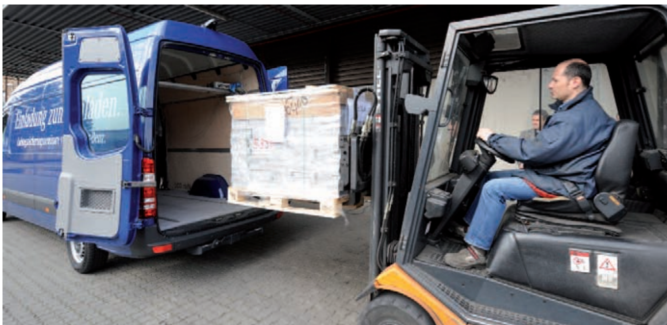
Beladung des Versuchsfahrzeuges. Da die Paletten bis kurz vor die Hinterachse geschoben werden mussten, konnten keine Anti-Rutsch-Matten eingesetzt werden.
