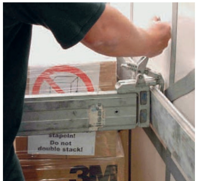
Klemmbrett zum rückwärtigen Fixieren (nach Möglichkeit nur als Kipp-sicherung verwenden!)
