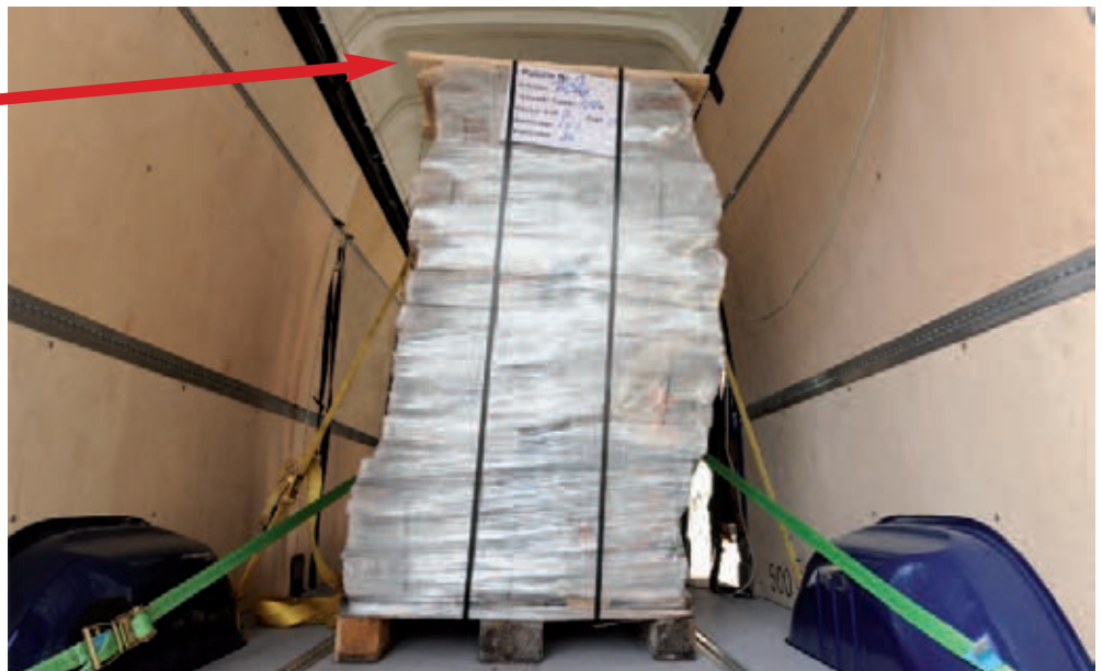
Die Kopfschlinge mittels Zurrurt und Palette fängt die Kräfte in Fahrtrichtung auf.
