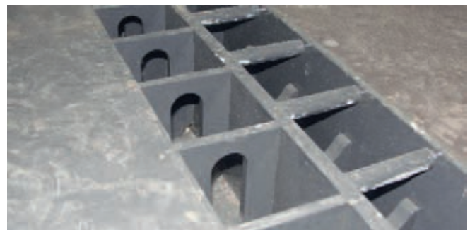
Rungentaschenreihe mit Zurrloch; Belastung Zurrlöcher 2.000 daN
