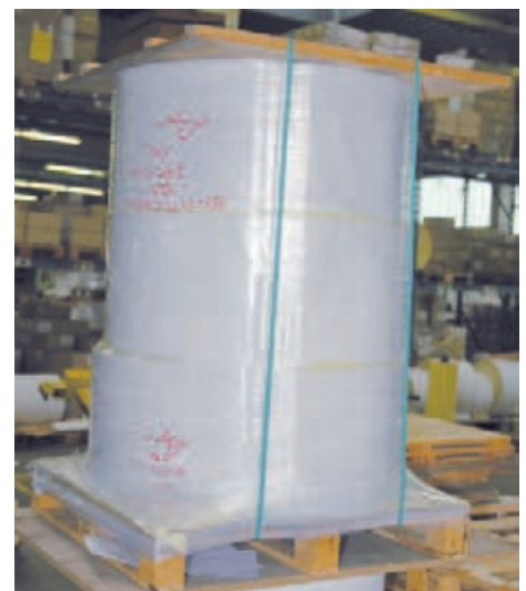
Kombination: Abdeckplatte, Umreifung, Folienstretzung
