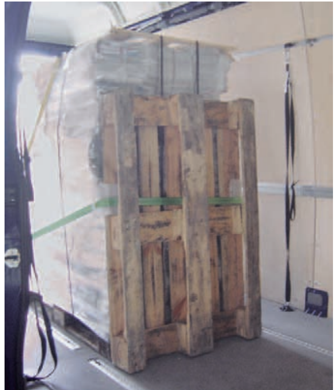
Die Kopfschlinge mittels Zurrurt und Palette fängt die Kräfte in Fahrtrichtung auf.
