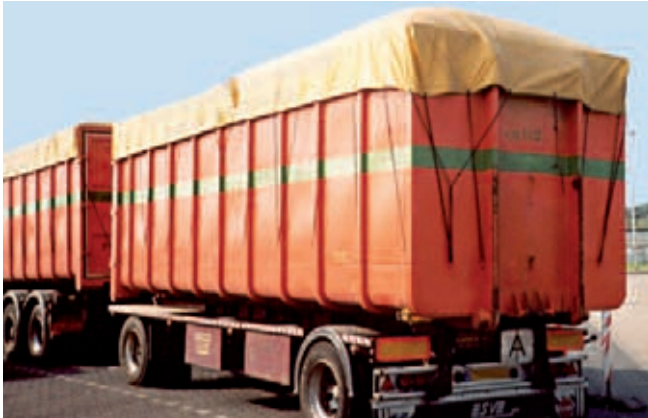
Beispiel für den Einsatz einer Abdeckplane
