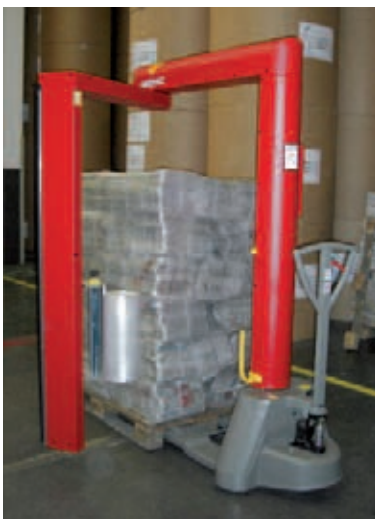
Mobiler, netzunabhängiger Hubwagen-Dreharmwickler
