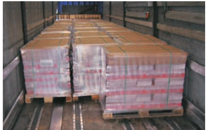
Kombination: Stülphaube aus Pappe, Umreifung, horizontale Folienstretzung
