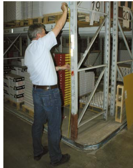
Abb. 6 Überprüfung der Fachhöhe
